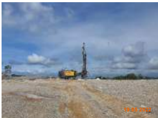
รูปที่ 2-11 เครื่องเจาะรูระเบิด ที่มีระบบ Cyclone และถุงกรอง
