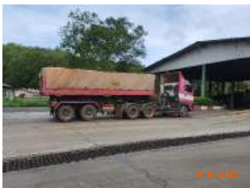
รูปที่ 2-13 ผ้าใบปิดคลุมรถขณะขนส่งแร่
