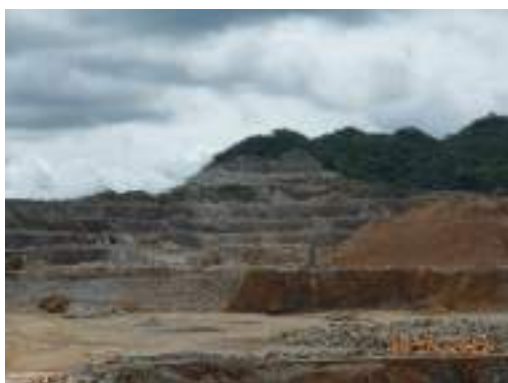
รูปที่ 2-2 ลักษณะการทำเหมืองแบบขั้นบันได เหมืองแร่หินปูนกลุ่มที่ 1 และ 2
